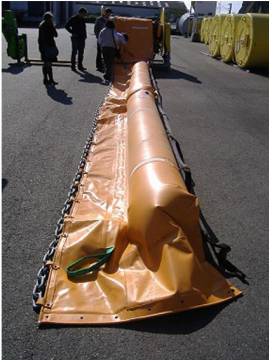
Figura 5: Exemplo de tipo de barreira de contenção. Fonte: Muttin (2015).
