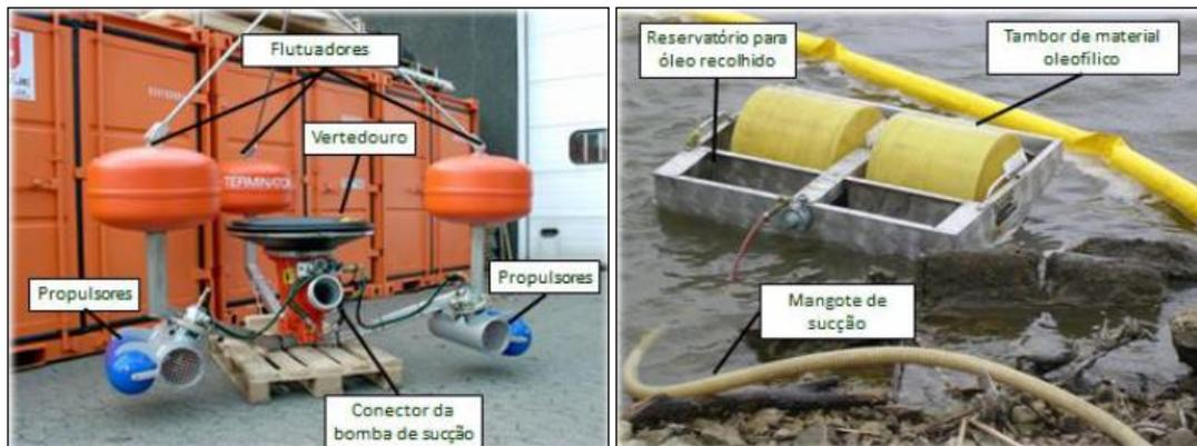
Figura 8-6: Exemplos de tipos de recolhedores de óleo (*skimmers*). Tipo vertedouro à direita e tipo oleofílico à esquerda. Fonte: Siqueira (2015).
