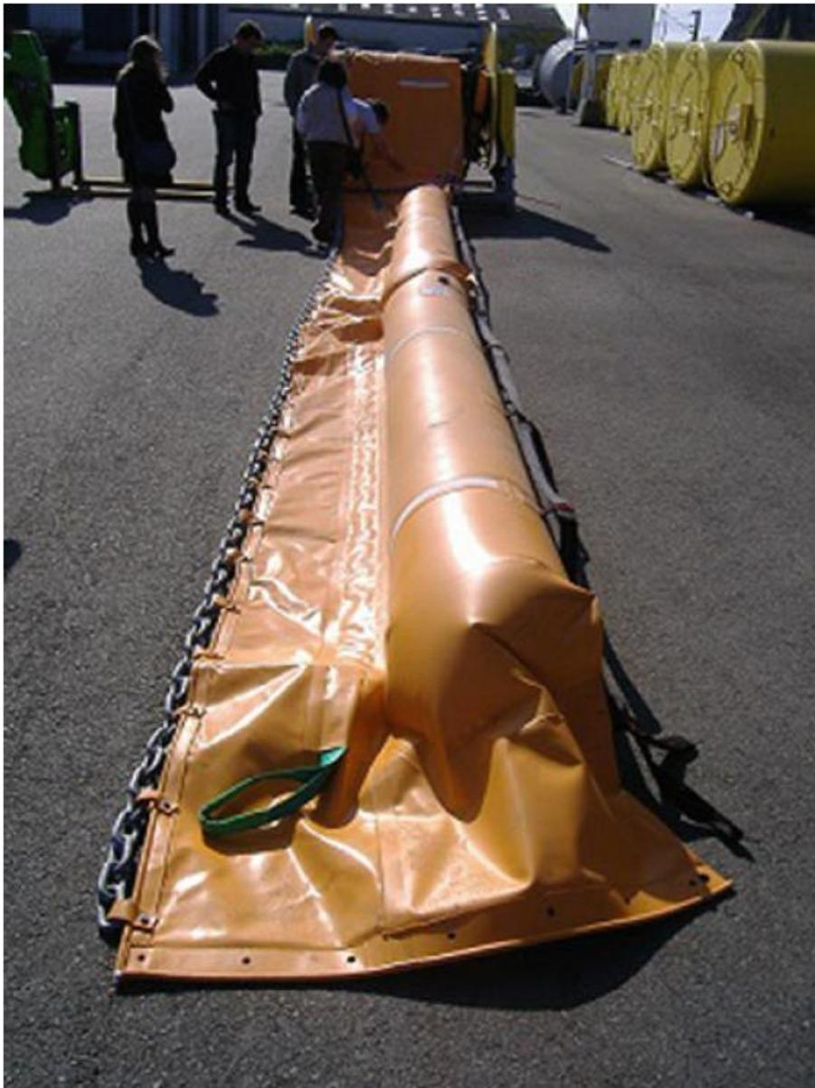
Figura 8-5: Exemplo de tipo de barreira de contenção. Fonte: Muttin (2015).
